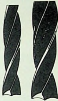
Die Schneidkanten verlaufen gekrümmt
