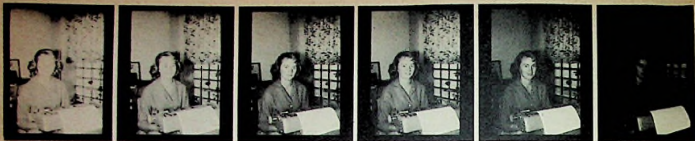
Bild 4. Testaufnahmen mit dem Ultrablitz Cornet. Von links nach rechts wurden die Einzelbilder mit den Blenden 2,8 - 4 - 5,4 - 8 - 11 - 16 gemacht. Im Druck lassen sich die Abstufungen des eigentlichen Negativstreifens nicht wiedergeben, mit Blende 16 erhält man jedoch bereits ein gut durchgezeichnetes Positiv
