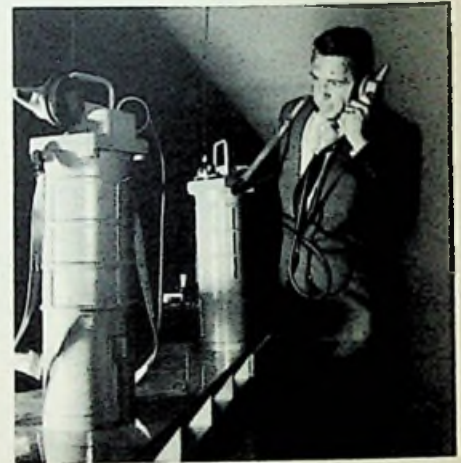
Ein äußerst stabiles Fußgehäuse, das allen rauen Beanspruchungen des Grubenbetriebes widersteht, schützt das schlagwettersichere Siemens-Funk-sprechgerät für den Bergbau
