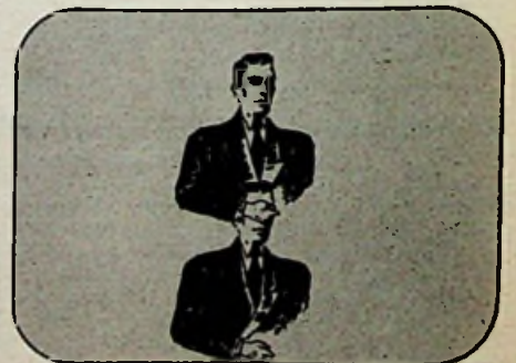
Bild 2. Die beiden schadhafte 22-nF-Kondensatoren veränderten den Einsatzpunkt des Sperrschwingers
